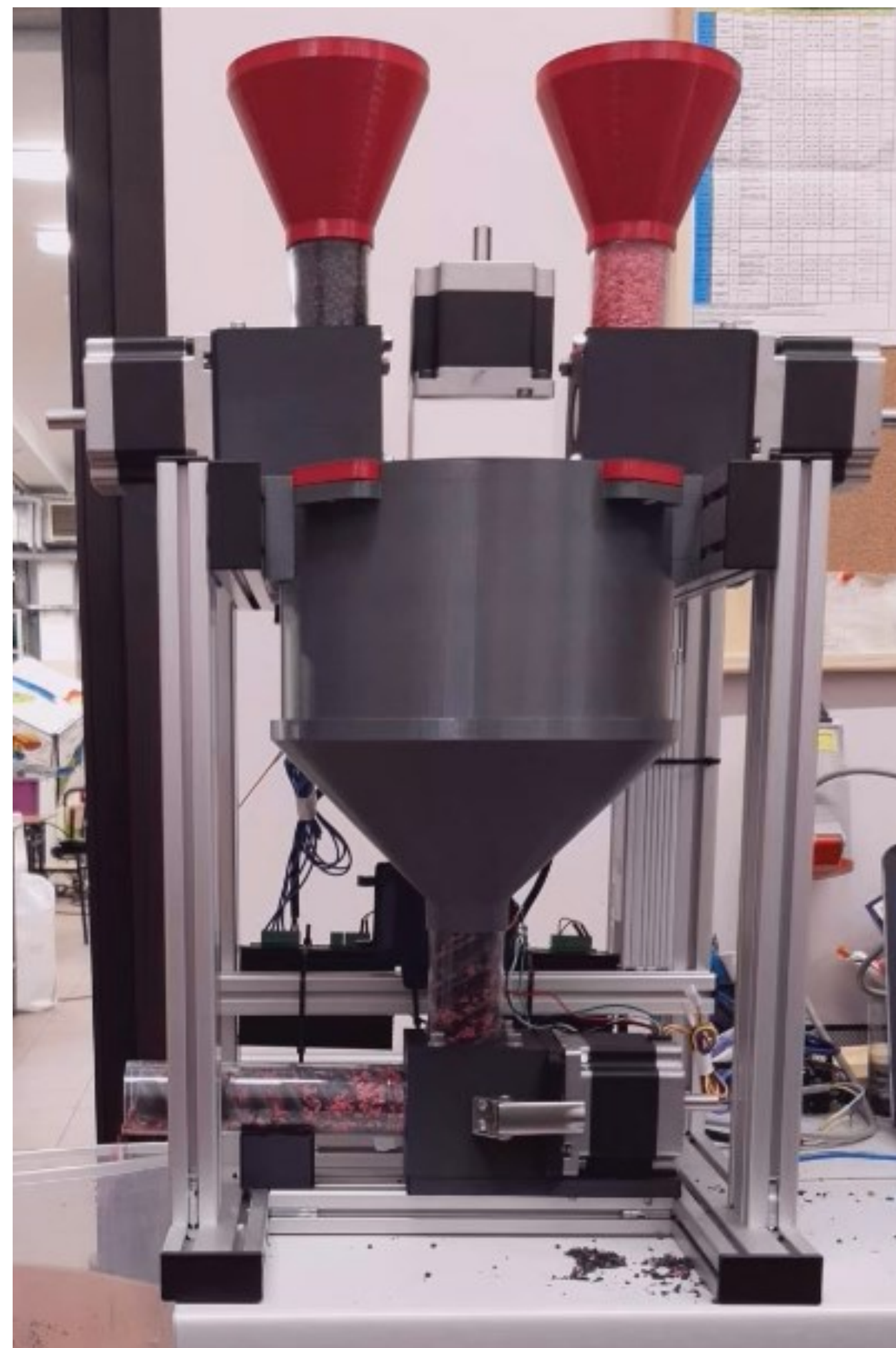
Rys. 3. Widok prototypu dozownika do recyklatów tworzyw polimerowych - stanowisko montażowe
